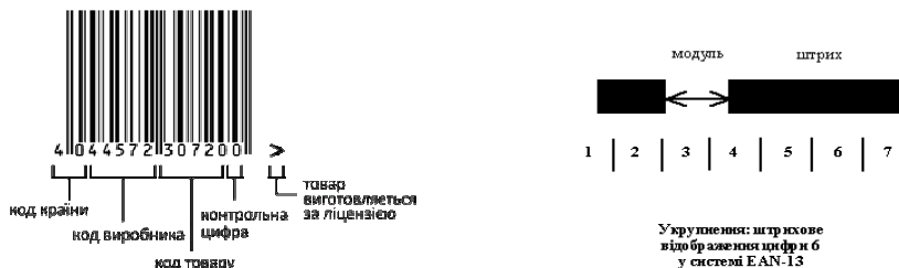
Рис. 5.2. Структура штрих-коду EAN-13
