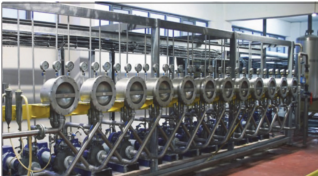
Рис. 11.4. Гідроциклонна установка для промивання крохмалю від глютену
