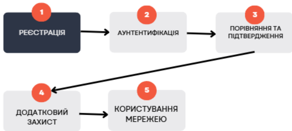
Рис.1.6 Алгоритм методу аутентифікації з використанням біометричних даних
