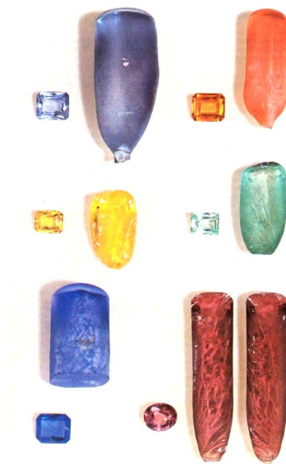
Рис. 1.26. Синтетичні кристали корунду та ограновані вставки
