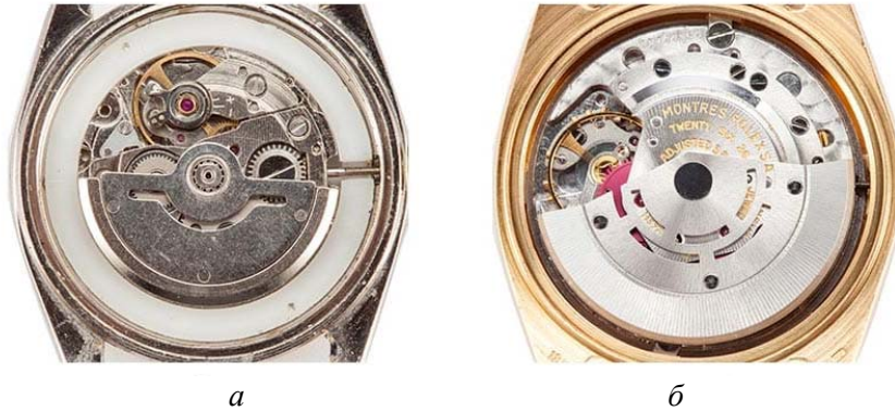
Рис. 5.32. Механізми годинників: а – підробка, б – оригінал 102
