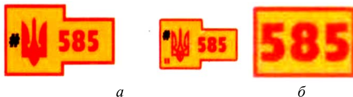
Рис. 19.5. Види пробірних клейм виробів із золота: а – основне ; б – додаткове
