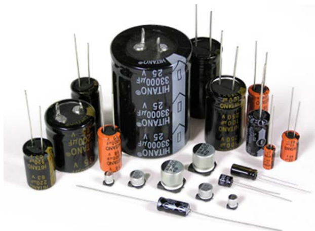
Рис. 15.1. Різні види конденсаторів
