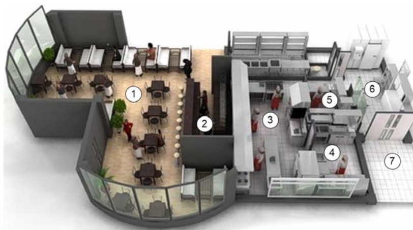
Рис. 2.12. Приклад просторового рішення міні-пекарні з власним кафе: 1 – торговельна зала; 2 – барна стійка; 3 – зона реалізації готової продукції; 4 – відділення замішування і формування; 5 – відділення оформлення і пакування; 6 – відділення розстоювання і випікання; 7 – завантажувальна
