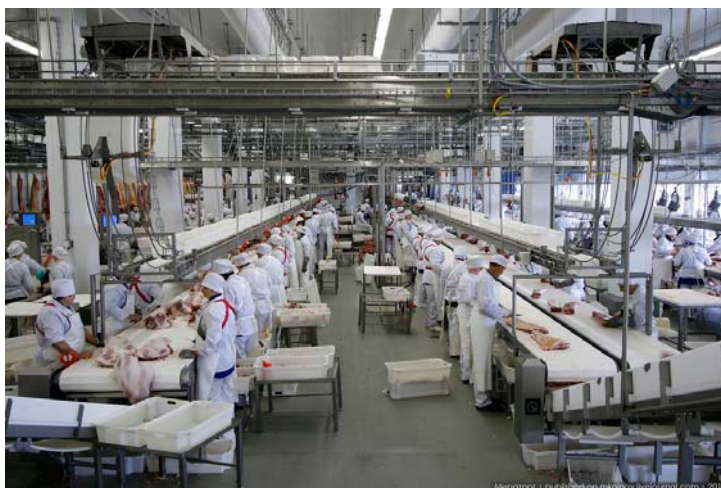
Рис. 2.32. Технологічна лінія виробництва м'ясних напівфабрикатів на фабриці-заготівельні Джерело: http://mkoinov.livejournal.com/77842.html
